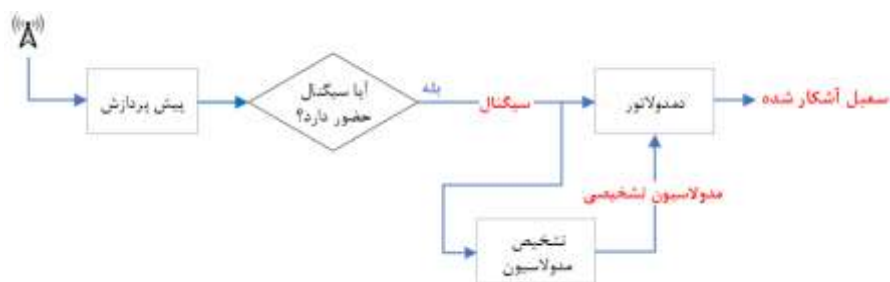
شکل (1) نمایش نقش تشخیص مدولاسیون در سیستم‌های مخابراتی بی‌سیم
